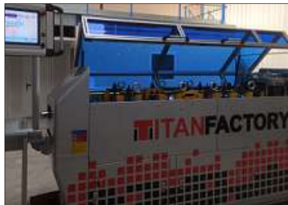
C'est cette machine qui permet de produire les profilés en acier qui constitueront la structure du bâtiment. (Photo DR)
